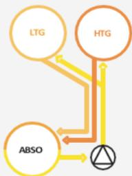
Divise le flux de solution de bromure de lithium (LiBr) entre les générateurs à basse température (LTG) et haute température (HTG) en deux voies parallèles équilibrées.
